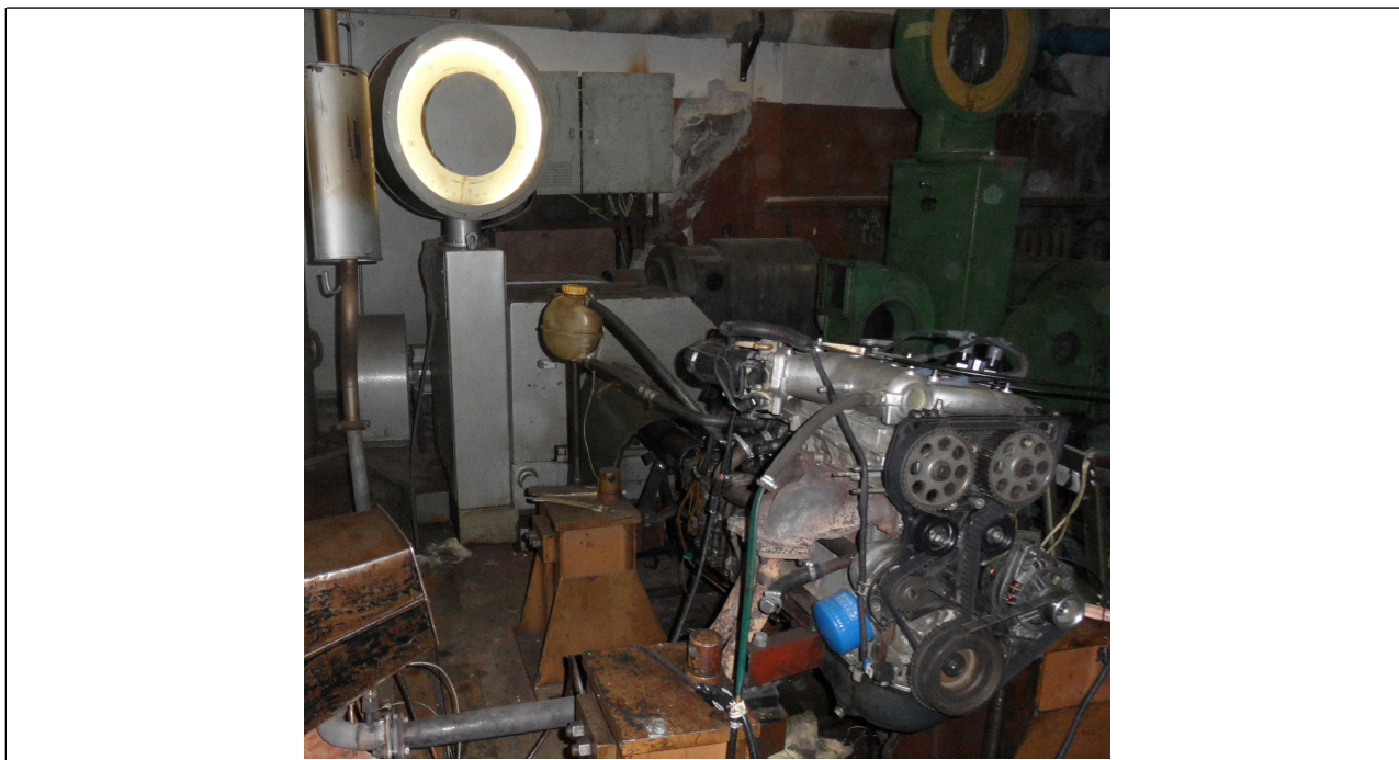
Рис.1. Стенд с двигателем ВАЗ-21126
